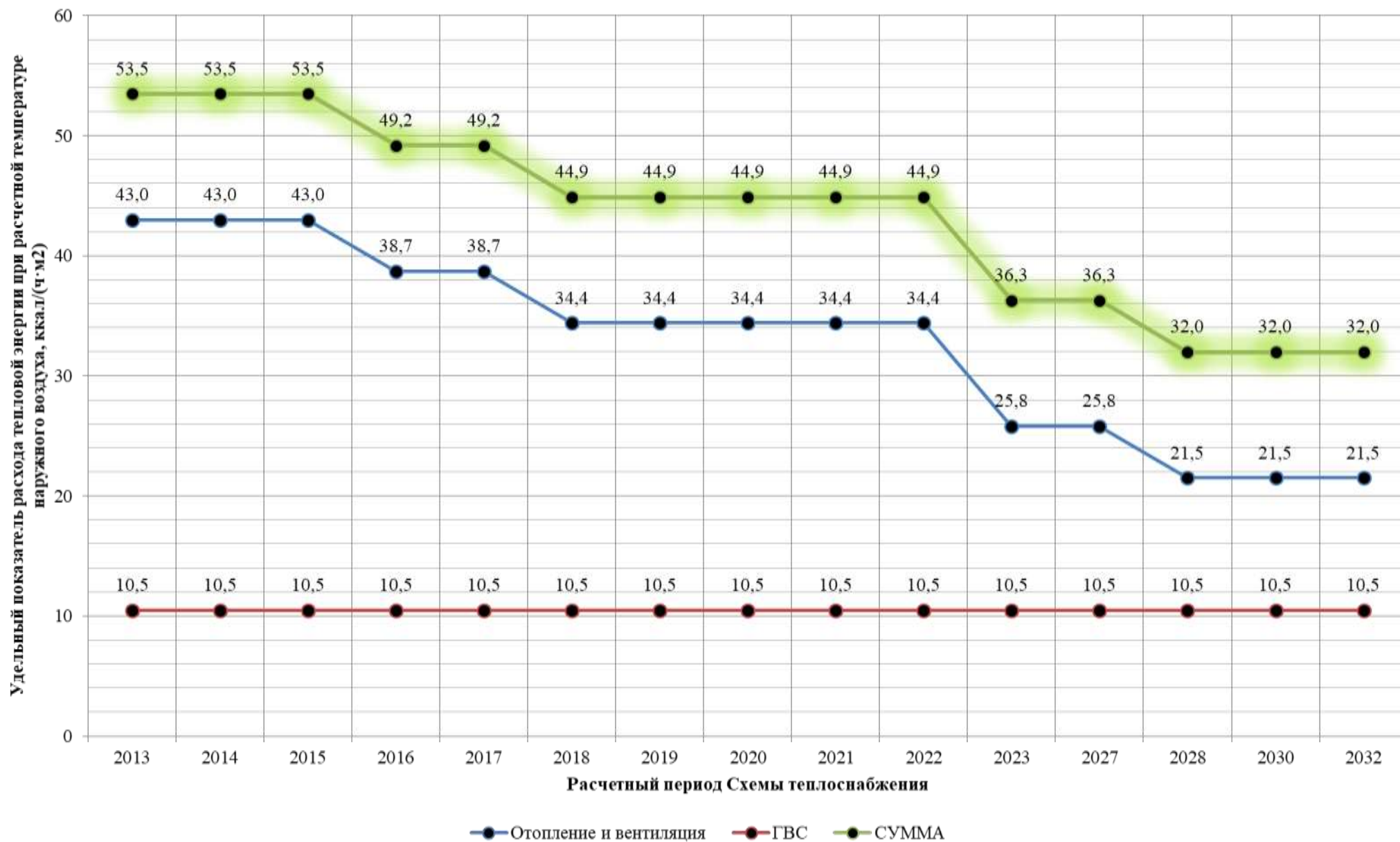
Рисунок 26 - Изменение нормируемого удельного расхода тепловой энергии на отопление, вентиляцию и ГВС на примере жилого 12-этажного многоквартирного дома
